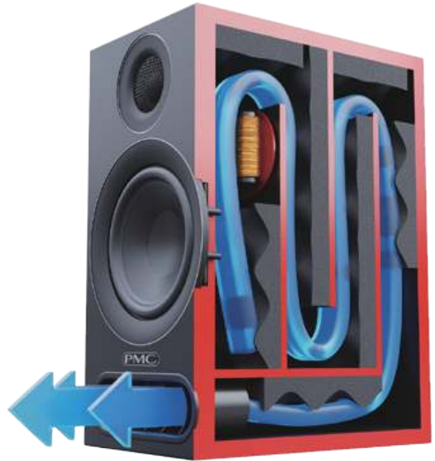
prodigy1 截面圖，展示ATL™與Laminair™之配置及低頻空氣流的運動方向
